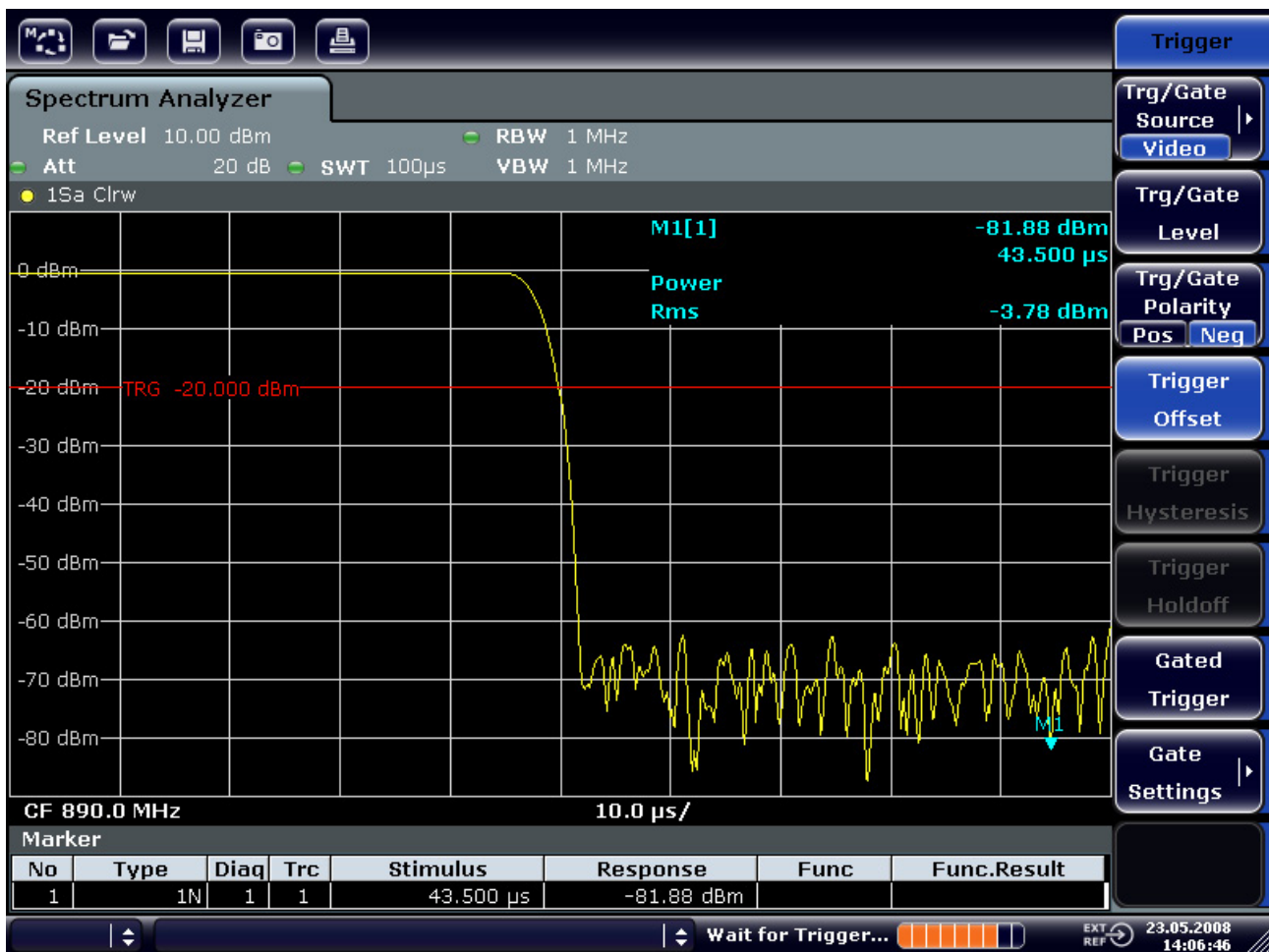
Figura 5-11: O Extremo da descida de impulso GSM apresentado com uma elevada resolução de tempo
